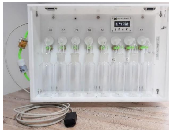
Слика 24. Изглед узоркивача 5G 8R_V1.1_PT
