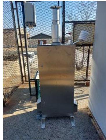
Слика 22. Изглед узоркивача Sven Leckel LVS3
