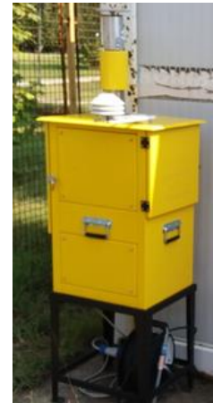
Слика 21. Изглед узоркивача LIFETEK PMS
