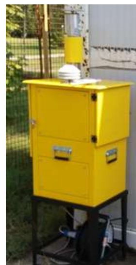
Слика 21. Изглед узоркивача LIFETEK PMS
