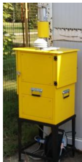
Слика 21. Изглед узоркивача LIFETEK PMS
