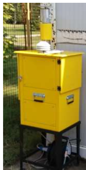
Слика 21. Изглед узоркивача LIFETEK PMS
